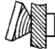
Krzywka pod ładunkiem. Im cięższy jest ładunek tym większy uchwyt.
